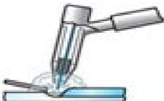
Gas-tungsten arc welding
